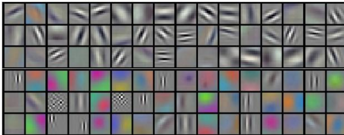
Filtros da primeira camada da rede neural AlexNet utilizando a base CIFAR-10.
