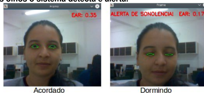
Figura 6. Resultado obtido: com o olho aberto, mostra apenas medição do EAR. Ao fechar os olhos o sistema detecta e alerta.
