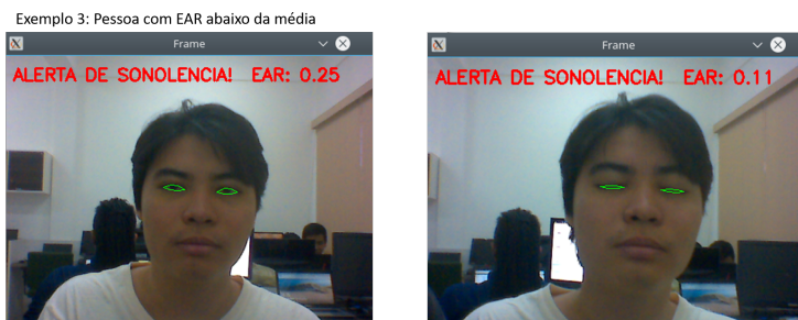
Figura 8. Caso de erro com medida de EAR para olho aberto fora do limiar configurado.
